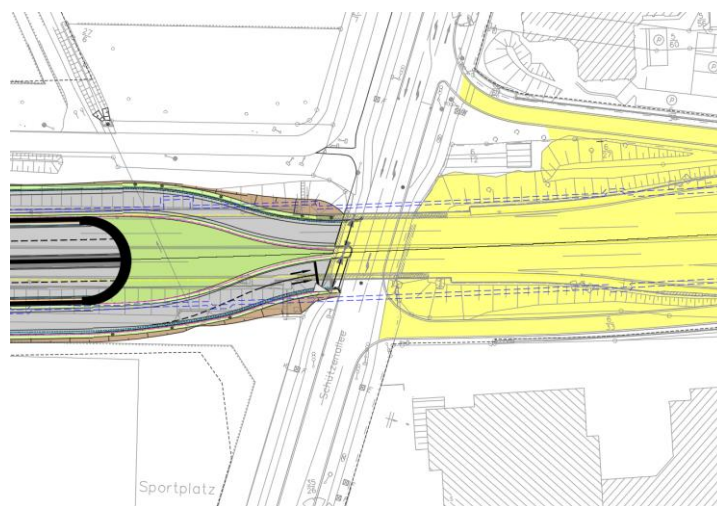
Abbildung 86: Neuer teilplanfreier Knotenpunkt Schützenallee
