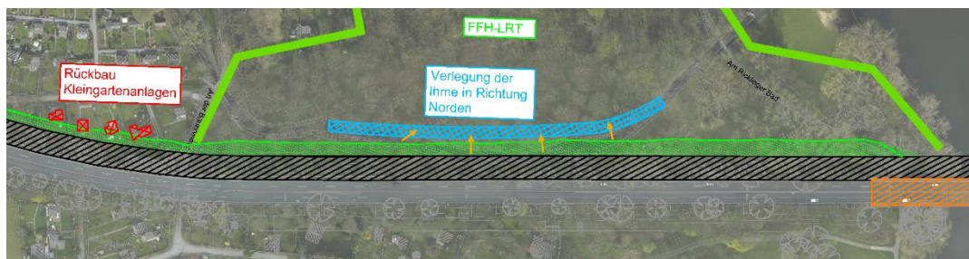
Abbildung 49: Verlegung der Ihme in Falle eines Ausbaus in Richtung Norden
