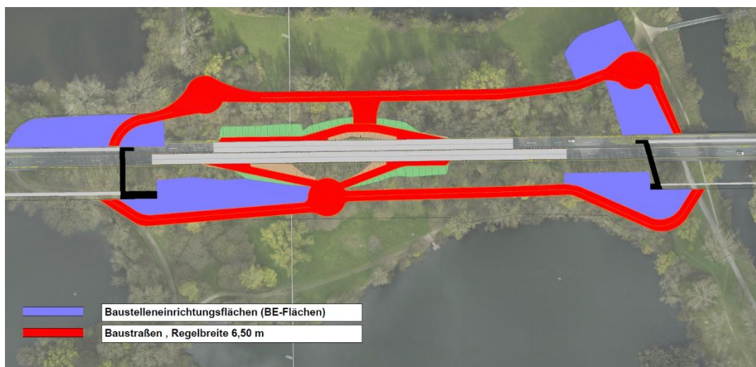
Abbildung 153: Vorgesehene Baustra ßen und BE-Fl ächen im Bereich zwischen der Br ücke über die Leineflutmulde (BW 05) und der Br ücke über die Leine (BW 06)
