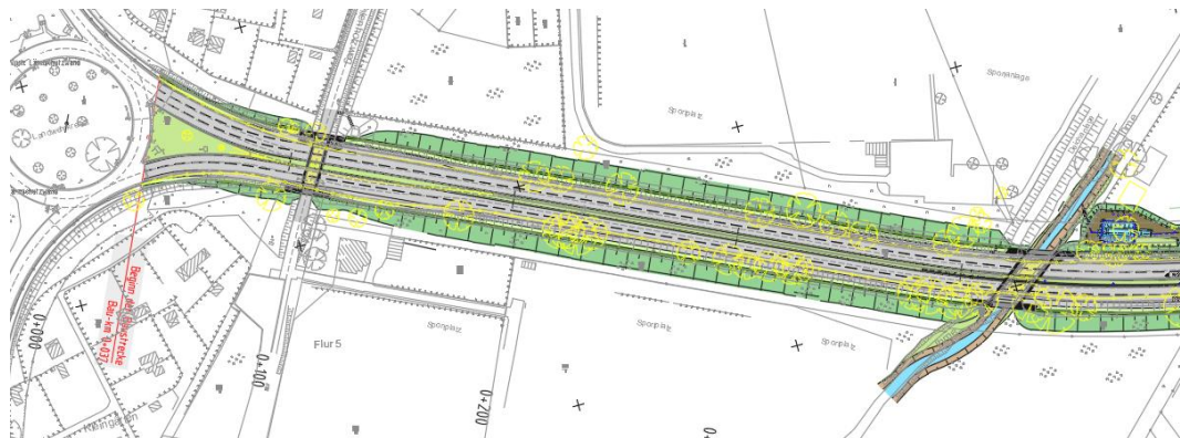
Abbildung 66: Symmetrische Verbreiterung des Südschnellwegs
