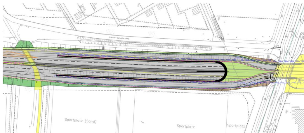
Abbildung 85: Geplante Ein- und Ausfahrrampen westlich der Schützenallee
