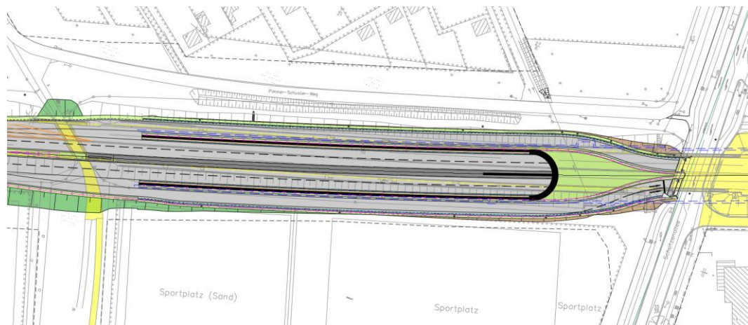
Abbildung 60: Neubau Ein- und Ausfahrampen westlich der Schützenallee
