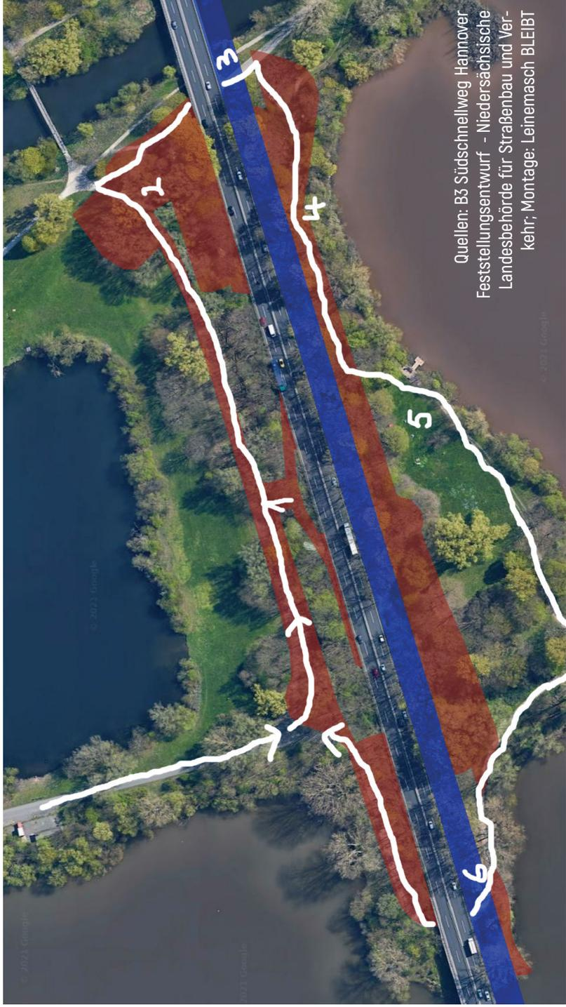
**Blau:** Fläche für die geplante **Fahrbahnerweiterung um fast zehn Meter**
